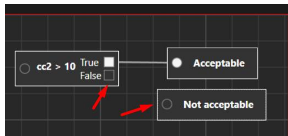
Abbildung 7.163 Bedingter Knoten mit angeschlossenem Ergebnisknoten „Acceptable“ (Annehmbar)
